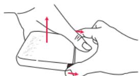
Håll kvar de två spärrarna i det nedre läget och håll din lediga hand under patronhållaren, med tummen på utlösningsanordningen (se bilden här intill).
